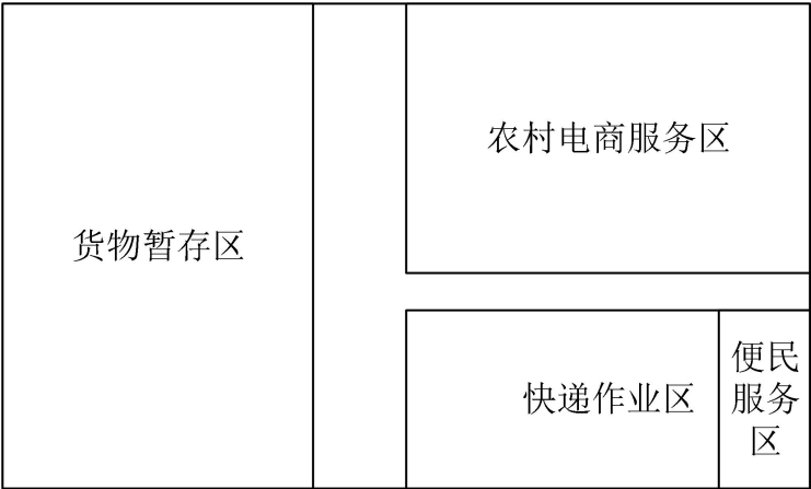
图 4-9 村级物流服务站布局示意图（按需设置，原则上不低于 10m 2 ）
